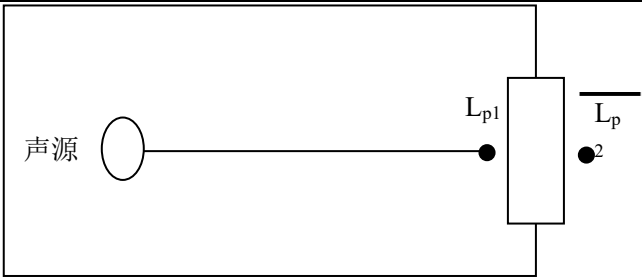
图 4.2-3 室内声源等效为室外声源图例
