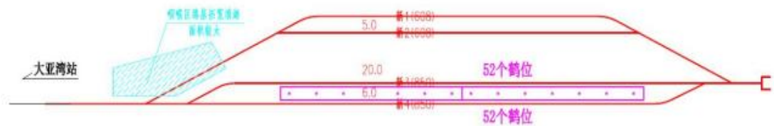
图 2-8 方案三：站场北头取直新建路基（远期方案） 表 2-10 方案优缺点分析
