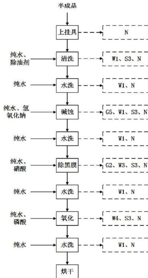
图 2-9 现有项目运营期 T 处理线生产工艺和产污环节流程图
