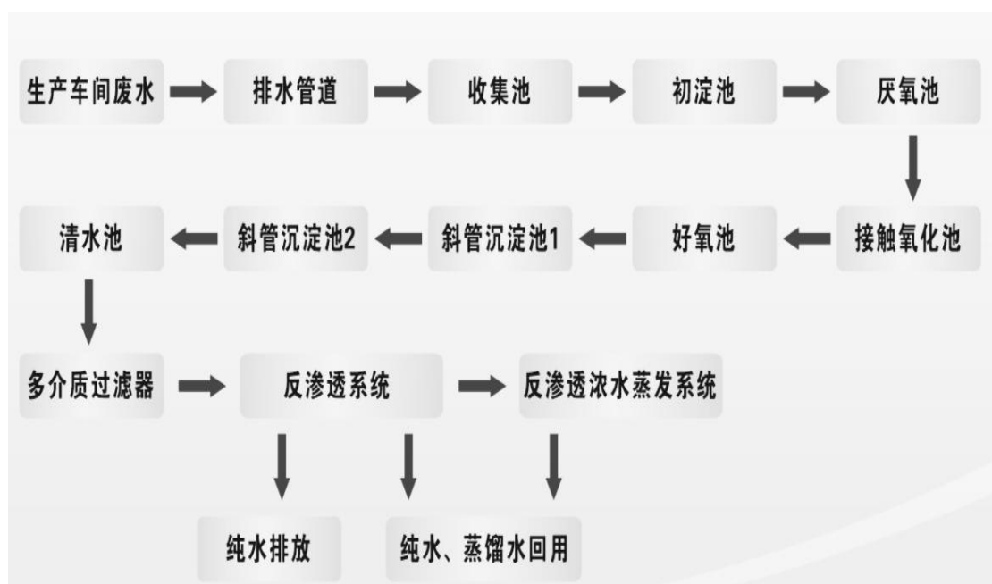
图 2.11-8 废水处理工艺流程图
