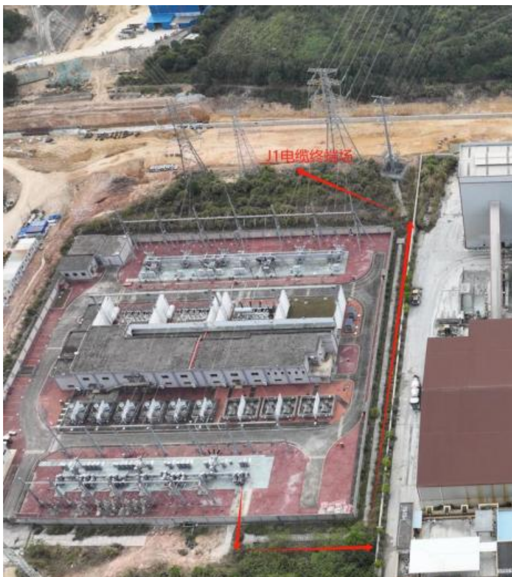
图 2.8-1 电缆路径走向航拍图
