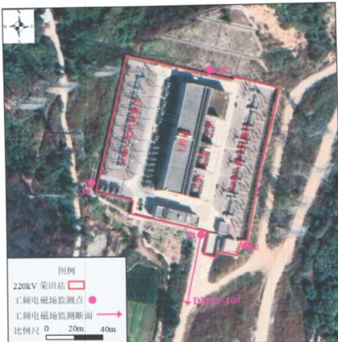
图 8.1-6 惠州 220 千伏荣田变电站类比监测点位布置图
