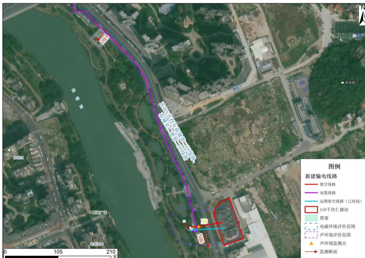
图 8.3-1 佛山 110kV 荷苏乙线与 110kV 荷仁乙线双回线路类比监测布点图
