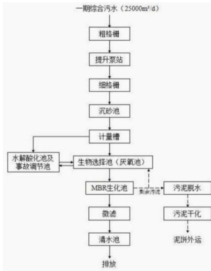
图 4-2 大亚湾石化区综合污水处理厂一期综合污水处理工艺流程图
